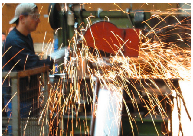
Abb. 1-06: Trennschleifmaschine für Gusssteiger, Linearführung DKLF2/43-80/1K mit pneumatischem Vorschub, Trockenlauf
