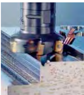
Einfahrt per „Roll-In“ Verfahren Verschleiß nach 800 Bearbeitungsgängen
