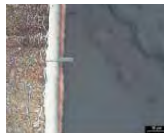
Diffusionszone, Verbindungsschicht 36µm
