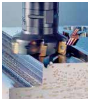
Einfahrt per „Roll-In“ Verfahren Verschleiß nach 800 Bearbeitungsgängen
