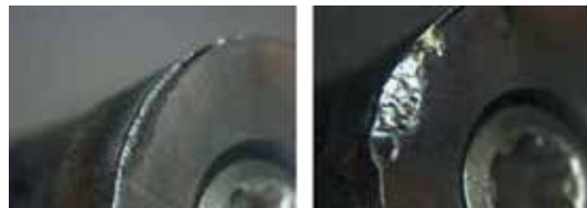
Einfahrt per „Roll-In“ Verfahren Verschleiß nach 800 Bearbeitungsgängen
