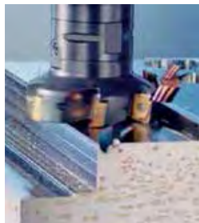
Einfahrt per „Roll-In“ Verfahren Verschleiß nach 800 Bearbeitungsgängen
