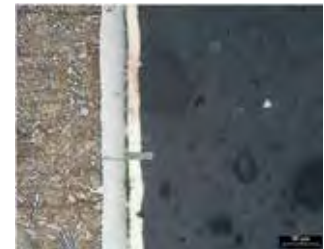
Diffusionszone, Verbindungsschicht 34 µm
