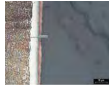
Diffusionszone, Verbindungsschicht 36µm
