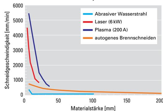
Bei niedriger Vorschubgeschwindigkeit wird die Wärmeeinflusszone größer, Restspannungen werden geringer, die Rissgefahr sinkt. Man bedenke, dass langsames Schneiden nicht so zuverlässig Risse vermeidet wie Vor- oder Nachwärmen. Die Geschwindigkeit in der oberen Abbildung sollte, abhängig von der Blechdicke, nicht überschritten werden.
