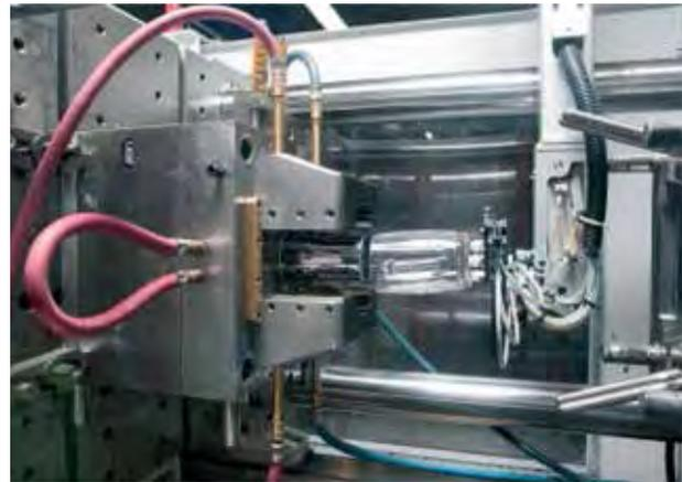
Toolox® wurde ursprünglich als Kunststoff-Formenstahl entwickelt, bald schon erwies dieser Werkstoff sich als außerordentlich geeignet für eine Vielzahl von weiteren Anwendungen.
