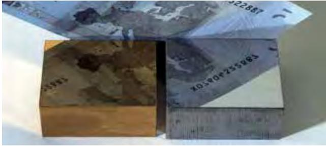
1. Feinschliff mit einem groben Schleifmittel (z.B. Korngröße 120). Alle Spuren der Verarbeitung oder des Erodierens werden hierbei komplett abgeschliffen. Vorzugsweise sollte hierbei die flache Seite des Schleifmittels zum Einsatz kommen. Variieren Sie die Schleifrichtung in X-Form, um eine absolut flache Oberfläche zu erzielen, Ihre Arbeit effizienter zu gestalten und gleichzeitig Zeit zu sparen.
